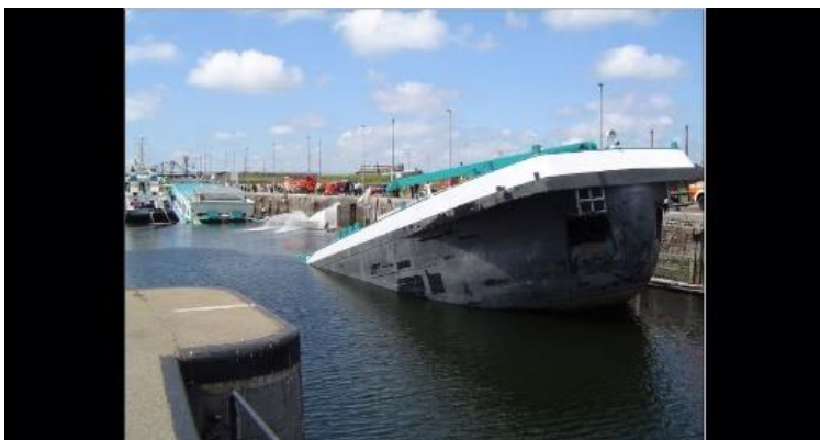
Afbeelding 2: Plooiën van een beunschip (Onderzoeksraad voor Veiligheid, 2006c)
