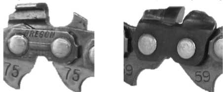
Figuur 12: Voorbeelden van zaagtanden met een verschillend grijpvermogen
