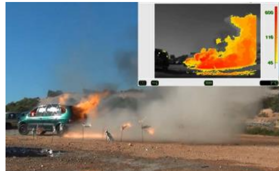
Foto 2: experiment voertuigbrand met waterstof. Aix en Provence, 2014 - Fakkel bij waterstofvoertuig (700bar) - Zichtbare vlam is klein deel van grote onzichtbare vlam - Totaal duurt vlam/afblazen +/- 30 seconden. Onder hoge druk (veel geluid >140dB)
