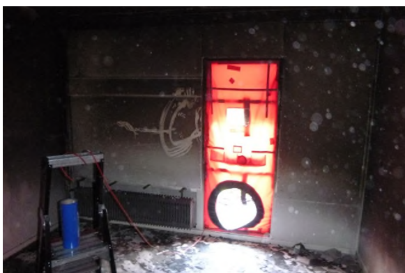
Foto 3: opstelling blowerdoor in 1.19
