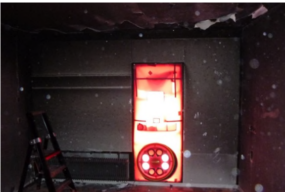
Foto 1: opstelling blowerdoor in 1.21
