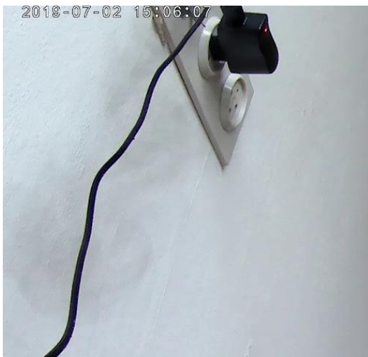
Figuur 2 Rook uit wandcontactdoos, test 13 woning 2.19
